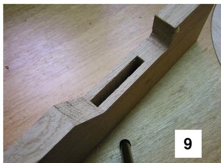
Faire les mortaises dans les montants (photo 9) puis les tenons aux extrémités des traverses.
