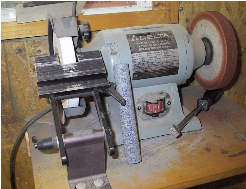
Fig. 15 : Touret de 6 pouces, meule d'oxyde d'aluminium, roue de feutre chargée de tripoli, dressoir au carbure et dressoir au diamant.
