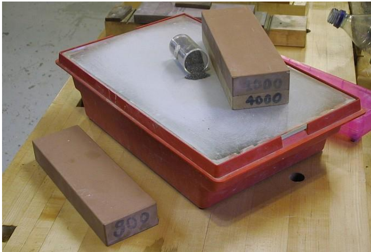
Fig. 19 : Pierres à eau et le nécessaire pour l'aplanissement des pierres
