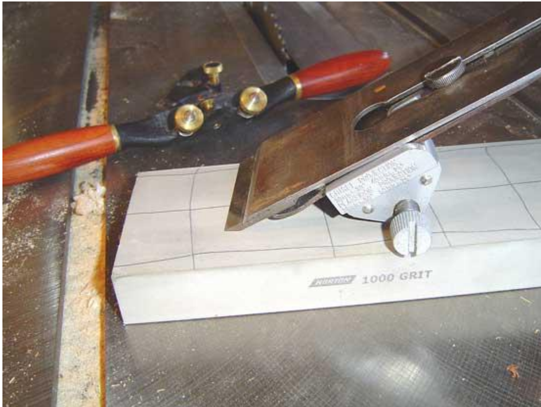
Fig. 13 : Utilisation d'un fer et contrefer de rabot pour tenir fermement une lame de vastringue.
