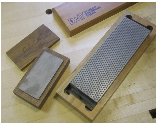
Fig. 16 : Pierre diamantées monocristalline à droite et polycristalline à gauche. Photo C. L.
